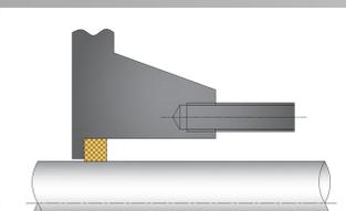
1リング目のグランドパッキンはシーリング材を塗布せずにそのまま挿入します。
