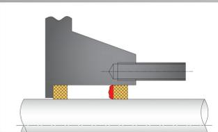
2リング目のグランドパッキンはシーリング材を塗布して挿入します。
